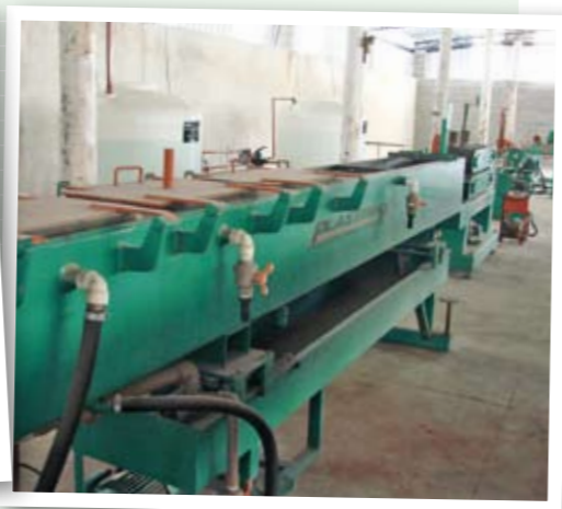
Equipamentos para a execução do processo de beneficiamento do plástico na Rede Cata-Vida. Estrutura montada fará a extrusão em granulados e a transformação dos polímeros em canos e tubos para esgoto.
