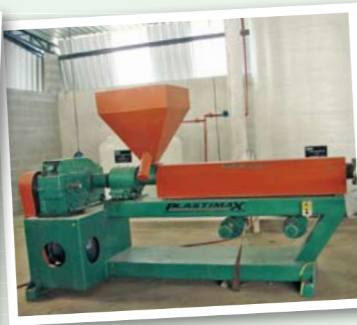
Equipamentos para a execução do processo de beneficiamento do plástico na Rede Cata-Vida. Estrutura montada fará a extrusão em granulados e a transformação dos polímeros em canos e tubos para esgoto.
