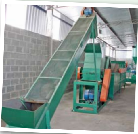
Equipamentos para a execução do processo de beneficiamento do plástico na Rede Cata-Vida. Estrutura montada fará a extrusão em granulados e a transformação dos polímeros em canos e tubos para esgoto.
